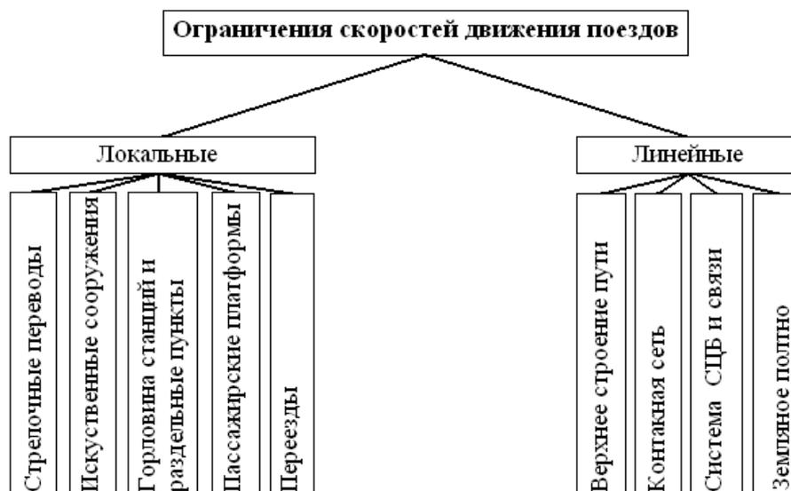
Рис.1. Классификация ограничений скоростей движения поездов.
