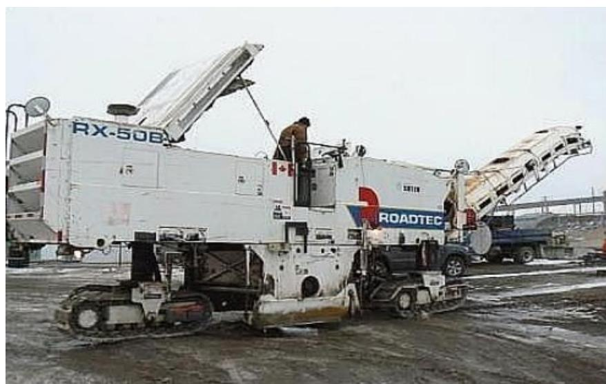
Рис.7. Общий вид фрезы Roadtec RX 50B
