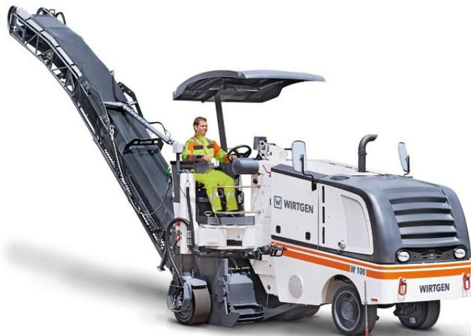
Рис.6. Общий вид фрезерной машины нового поколения модели W 1000 фирмы "Wirtgen GmbH"
