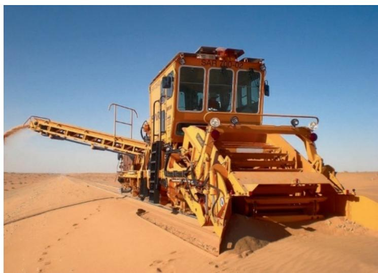
Рис. 2. Удаление песка машиной SKM500
