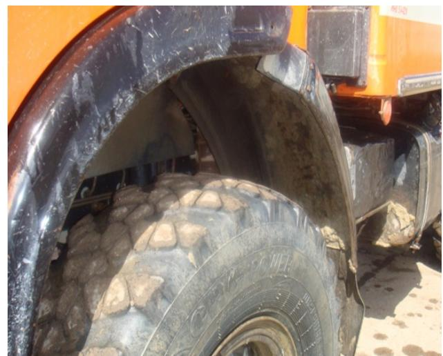
Рис.5. Состояние подконтрольной шины переднего левого колеса автобус НефАЗ-4208-03 № 10.493QAA после пробега 43497км.
