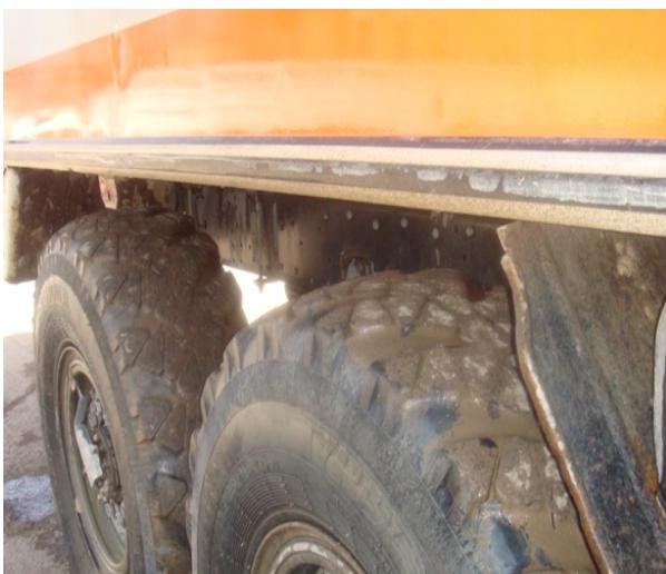
Рис. 4. Состояние подконтрольных шин среднего и заднего правых мостов автобуса НефАЗ-4208-03 № 10.493QAA после пробега 43497км
