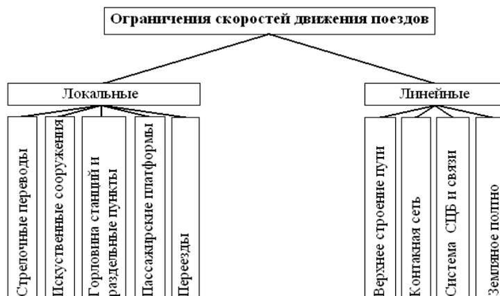
Рис. 1. Классификация ограничений скоростей движения поездов
